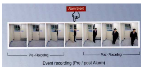
Enregistrement d'évènements (Pré / post Alarme)
